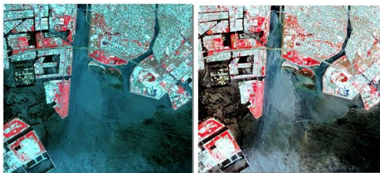
Hình 3.11. Ảnh vệ tinh trước và sau khi biến đổi độ xám
